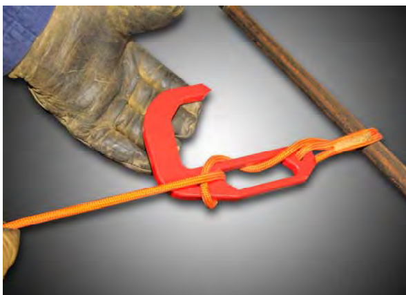
Рисунок 8 – Закрепление крюка за горизонтальную конструкцию.
