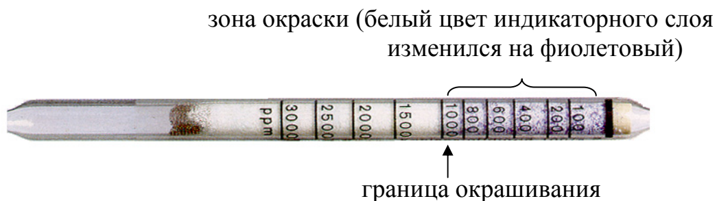
Рис. 11 Индикаторная трубка «Carbon dioxide 100/a-P» после проведения измерений (пример)
