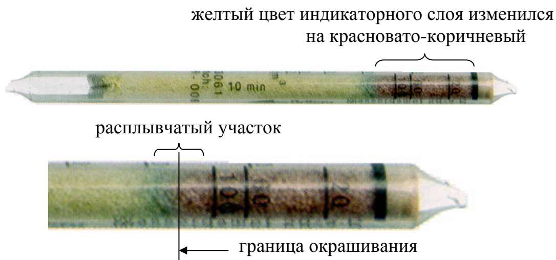
Рис. 13 Индикаторная трубка «Water vapour 20/a-P» после проведения 10-минутного измерения (пример)
