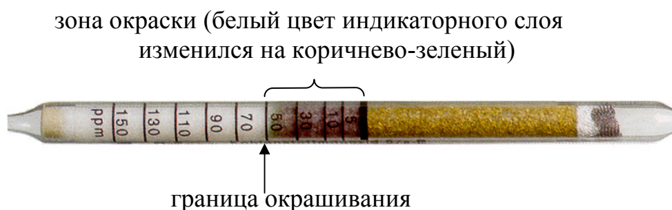
Рис. 9 Индикаторная трубка «Carbon monoxide 5/a-P» после проведения измерений (пример)
